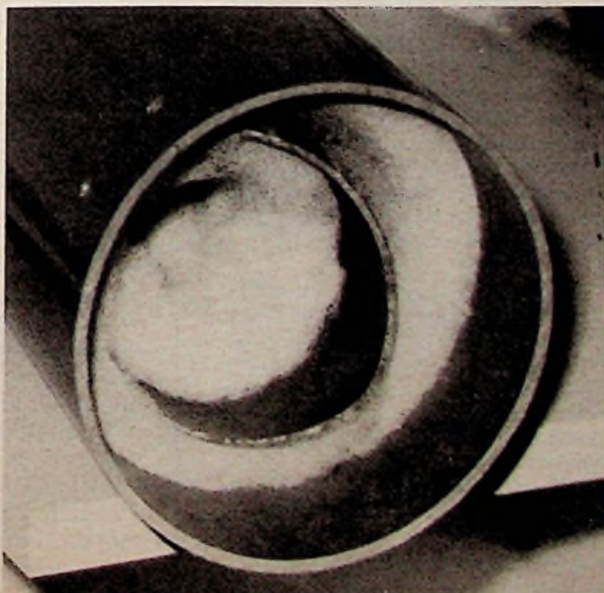
Afb. 9 Zo ziet de onderzijde van de Soundtube eruit kort voordat de aansluitbussen werden gemonteerd en vastgesoldeerd en de bodem erin werd gelijmd. Zowel de binnen- als de buitenbuis werden van dempingsmateriaal voorzien.
