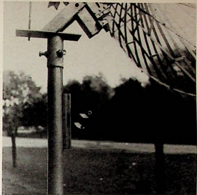
Afb. 8 De direct afleesbare helling- of inclinometer van afb. 6 is hier gebruikt om de zuil verticaal te stellen. De ingebouwde magneten kleven de hellingmeter stevig vast.
