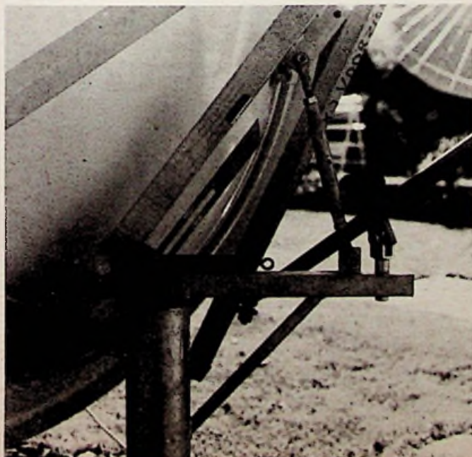
Afb. 7 Met behulp van een ouderwetse „zwaaihaak”, vooraf op 53^\circ gebracht met een gradenboog, kan de helling van de hoofdas op plaatselijke breedte worden ingesteld.
